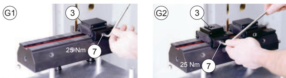
Bei Mehrfach-Werkstückspannung die Werkstücke in der abgebildeten Reihenfolge leicht vorspannen.
