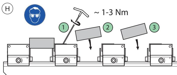
Wenn mehrere Spannelemente zum Einsatz kommen, beim Spannen die Reihenfolge, wie im Bild I abgebildet, einhalten.
