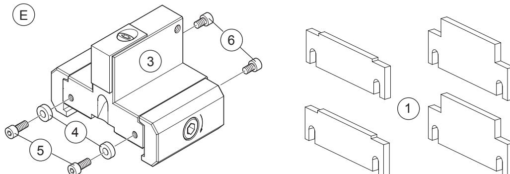
Parallelunterlagen (1) nach Bedarf wie abgebildet anbringen und Zylinderschrauben M5 x 14 (5) und M5 x 10 (6) mit 4 Nm festziehen.
