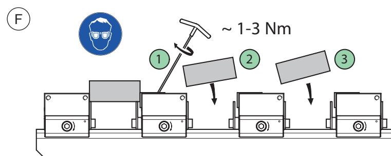
Wenn mehrere Spannelemente zum Einsatz kommen, beim Spannen die Reihenfolge, wie im Bild G abgebildet, einhalten.
