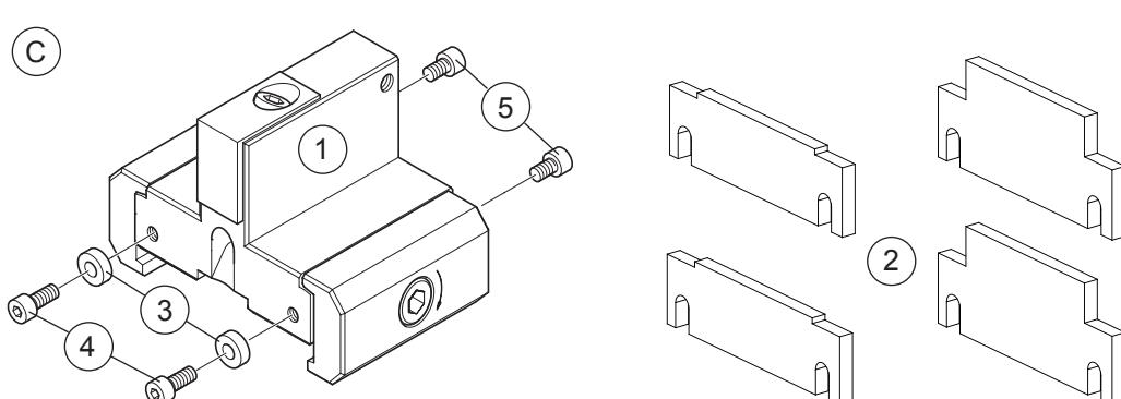
Parallelunterlagen (2) nach Bedarf wie abgebildet anbringen und Zylinderschrauben M5 x 14 (4) und M5 x 10 (5) mit 4 Nm festziehen.
