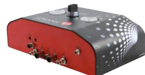
Die ab Werk montierten Stopfen auf den Anschläüssen P2 bis P6 durch die beigelegten Anschraubanschlüsse ersetzen.
