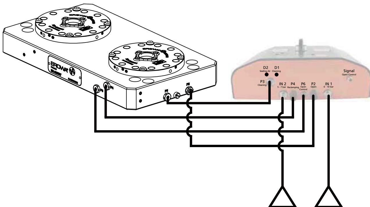
**9. Bedienung mit der EROWA MTS Steuereinheit manuell ER-099200**
