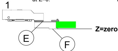
Um die Z-Auflage ausserhalb des Kollisionsbereichs zu heben, kann die Zwischenplatte (E) demontiert werden. Nun sind die Z-Auflage (F) ausserhalb der Kollisionszone.
