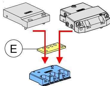
Pour déplacer les appuis Z en dehors de la zone de collision, il suffit de démonter la plaque sandwich (E). Les appuis Z (F) se trouvent alors en dehors de la zone de collision.
