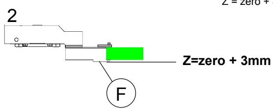
Die Lage der Werkstücke auf EROWA PreSet 3D oder EROWA PreSet Basic Uno PalletSet W ermitteln und Daten an die WEDM Anlage übergeben.
