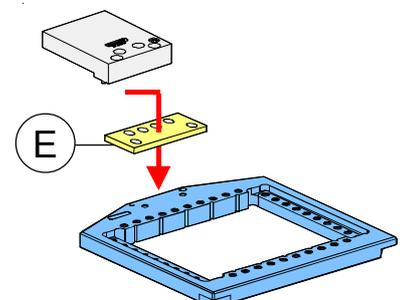
Die Lage der Werkstücke auf der PreSet 3D von EROVA ermitteln und Daten an die WEDM Anlage übergeben.
