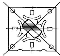
Bei der Montage des Spannzapfens muss darauf geachtet werden, dass die Klinke (G) des Greifers oder Wechslers (Rundmagazin, Linearwechsler, Robot) in der Einfrässung (H) des Spannzapfens einrastet. Um diese Position zu erreichen kann man den Spannzapfen um die oben genannten 4 x 90° drehen.
