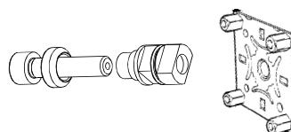
Der mitgelieferte Spannzapfen (D) muss so montiert werden, dass er beim Einschrauben in den Aussparungen (E) der Zentrierplatte (F) einrastet. Dies ergibt vier Möglichkeiten, um den Spannzapfen nach Bedarf zu montieren.
