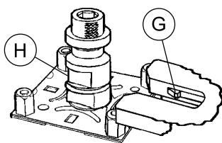
M10 Schraube mit 35 Nm anziehen.
