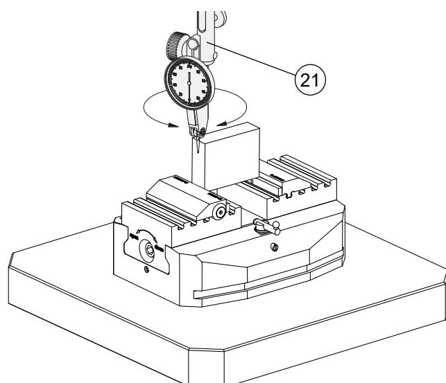
Muss der Nullpunkt nachjustiert werden, kann durch lösen und kontern der Gewindestifte (3) der Nullpunkt des Zentrumsspanners korrigiert werden.
