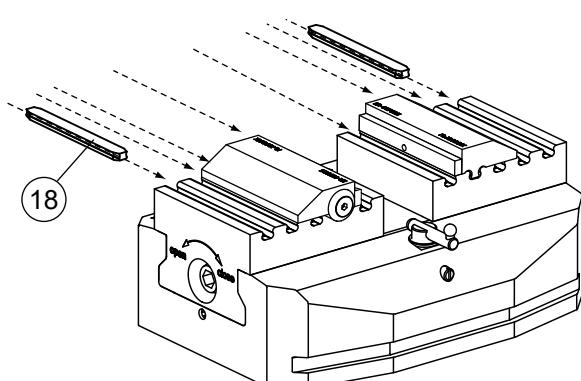
Zentrumspanner öffnen und Werkstück (19) einsetzen. Sechskanteinsatz (ER-068025, Option) auf den Drehmomentschlüssel (ER-068026, Option) aufsetzen. Anschliessend an dem Sechskant der Spindel (4) ansetzen. Mit einem maximalen Drehmoment von 60 Nm den Zentrumspanner schliessen.
