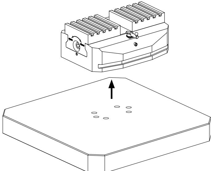
Den Zentrumspanner nach Bedarf demontieren, reinigen und einölen.
