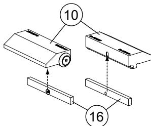
Die zwei Backen (10) mit montierten Unterlagen behutsam bis zu den Anschlägen (17) einsetzen.
