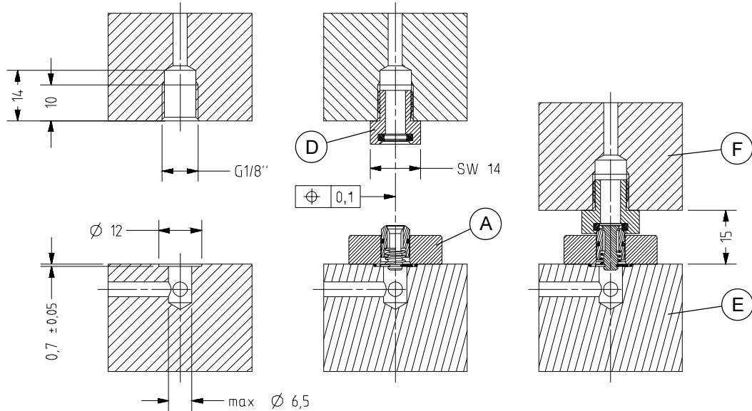
Bohrbild für Ventilplatte:
