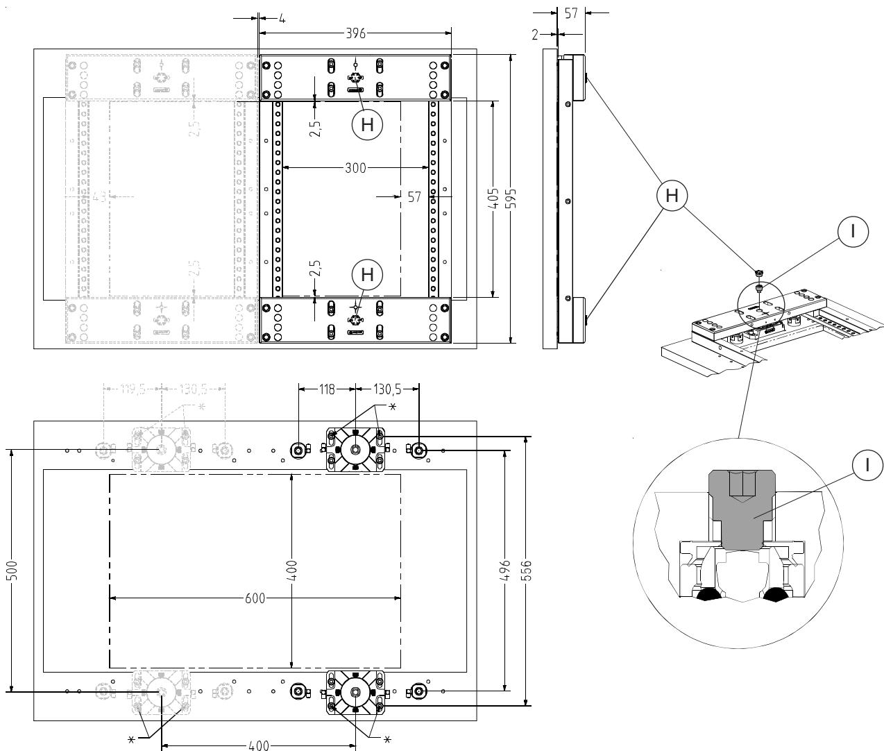
\* Zusätzliche Löcher für Spannfutter Befestigung (8 x M8).
