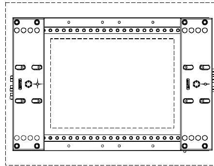
Um evtl. auftretende Wärmeausdehnungsfehler ausgleichen zu können wird der Spannrahmen im FSF 1 in den X und Y-Achsen zentriert, und in FSF 2 nur in der X-Achse.
