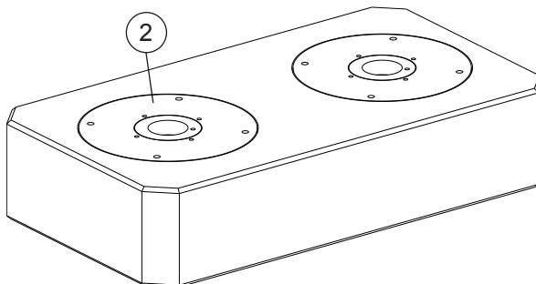
**Anwendung**Einsatz auf der EROWA MTS 81 Basisplatte 110 x 210 P oder der MTS 81 Basisplatte 110 x 210 P/A.
