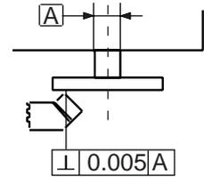
**Fehler im Planlauf der Pinole können bei der Montage des Spannfutters nicht mehr behoben werden.**
