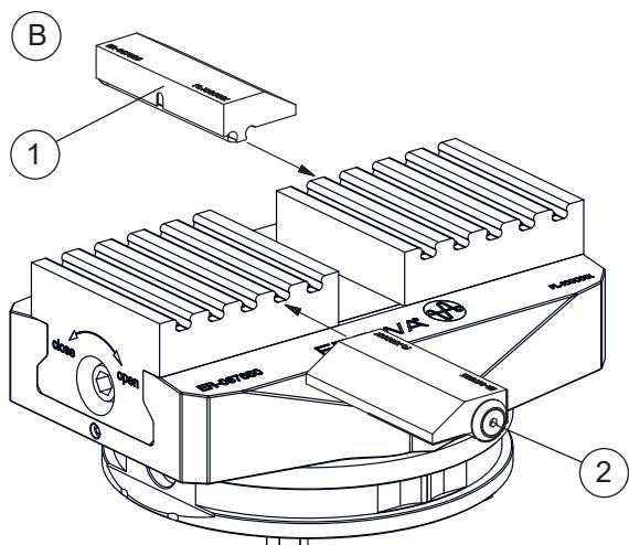
**Montage der Spannbacken mit Unterlagen, (Option ER-068158):**
