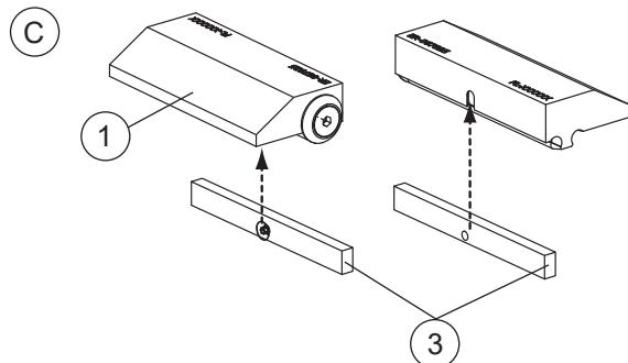
Die zwei Spannbacken (1) mit montierten Unterlagen behutsam bis zu den Anschlägen (2) einsetzen.
