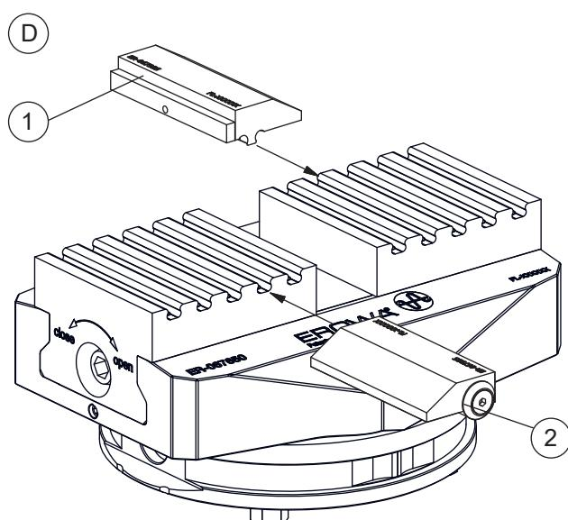
Zentrumspanner öffnen und Werkstück (4) einsetzen.
