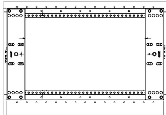
Um evtl. auftretende Wärmeausdehnungsfehler ausgleichen zu können, wird der Spannrahmen im FSF 1 in den X und Y-Achsen zentriert, und in FSF 2 nur in der X-Achse.
