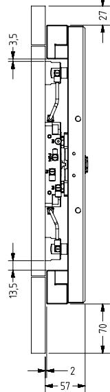
Zum Befestigen der Spannfutter (B) werden zusätzliche Gewinde M8 (T) benötigt.
