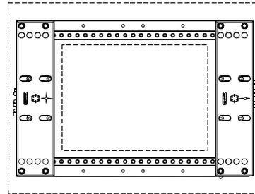
Um evtl. auftretende Wärmeausdehnungsfehler ausgleichen zu können, wird der Spannrahmen im Spannfüter 1 in den X und Y-Achsen zentriert, und im Spannfüter 2 nur in der X-Achse.
