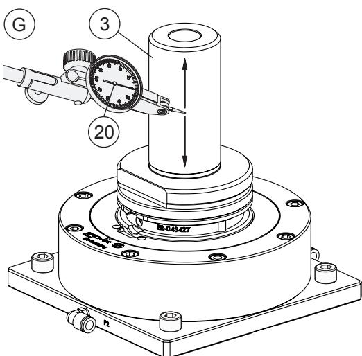
**Kontrolle der Winkellage an der Ausrichtfläche**
