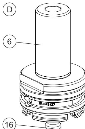
PowerChuck P (18, oder ITS Chuck P, usw.) betätigen, Ausrichtdorn (6) unter Berücksichtigung der Referenzmarken (1, 17) einspannen. Befestigungsschrauben (19) des Spannutters nur leicht anziehen, damit das Spannutter noch verschoben werden kann.
