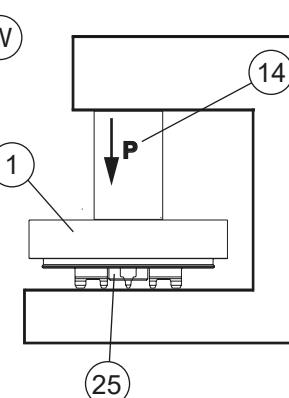
Das Futter kann wieder auf die entsprechende Oberfläche montiert werden mittels der 6 Schrauben M10 × 30 (12).
