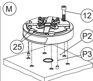
6 Schrauben M10 x 30 einsetzen und mit 45 Nm anziehen (12).
