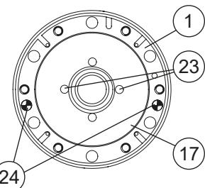
Gehäuse (1) mit montiertem Sperrring (17) unter eine Presse, Fräsmaschinenspinne, etc. (14) legen. (Bild W)
