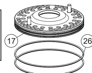
Sperrring (17) einzölen und so auf die Federn (4) montieren, bis alle Federn in die dafür vorgesehenen Bohrungen im Sperrring eingreifen.
