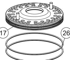
Sperrring (17) einölen und so auf die Federn (4) montieren, bis alle Federn in die dafür vorgesehenen Bohrungen im Sperrring eingreifen. (Bild I)
