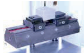
Exemple éléments de préhension (figure D)
