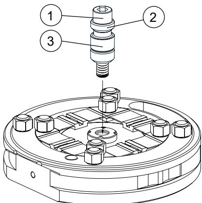
Durch den beweglichen Teil (2) werden allfällige Axialfehler des M10 Gewindes eliminiert.
